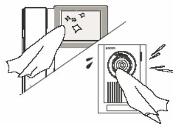
Чистое изображение получайте очисткой объектива вызывной панели и экрана монитора мягкой тканью.
