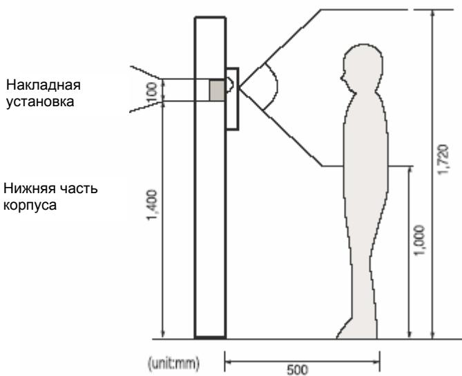
Стандартная высота установки вызывной панели 1400 -1450 мм от пола до корпуса панели.
