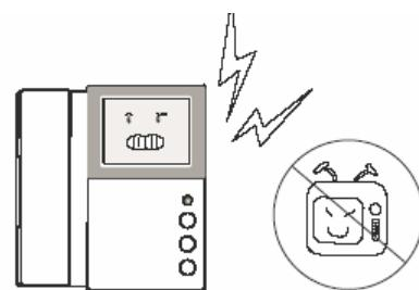
Избегайте наличия устройств, создающих сильные магнитные поля (ТВ, динамики и пр.). Может исказяться изображение и есть возможность повреждения монитора.
