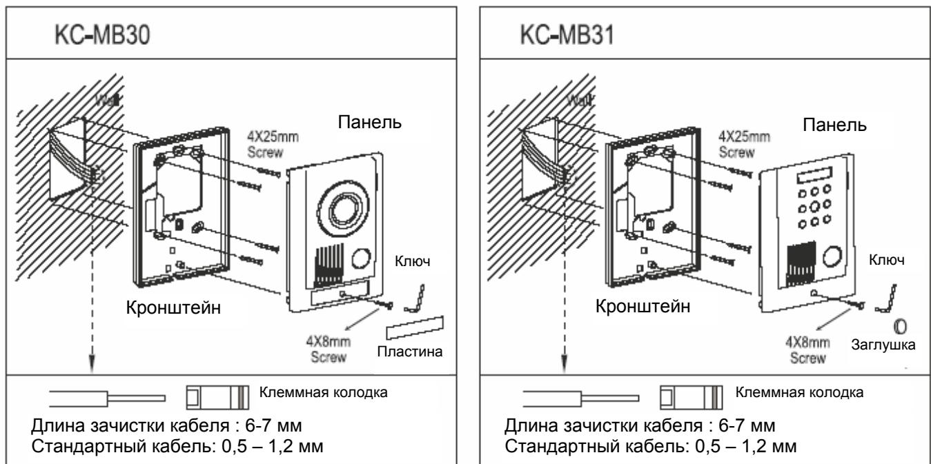
После фиксации кронштейна 4 шурупами, установите вызывную панель на кронштейн и зафиксируйте ее шестигранным ключом.
