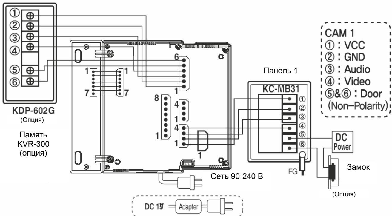
▪ Схема подключения. 2 вызывные панели и 1 монитор
